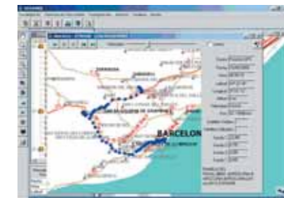
Historico de un vehículo, en todo momento se conoce la posición y la temperatura exterior y la de la caja.
