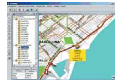
Vehículo parado que se encuentra realizando una entrega la temperatura del ambiente es 28,2 °C y la del camión es 7,1 °C.
